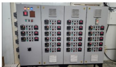
चित्र A.2.9: टिन-लिथियम लूप (बाएँ) का स्थिर-अवस्था तापीय विश्लेषण। PID आधारित तापमान नियंत्रक सक्रिय है और टिन-लिथियम लूप (दाएँ) के साथ एकीकरण के लिए तैयार है।
