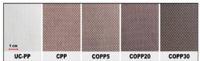
चित्र A.4.2: कोटेड और अनकोटेड वस्त्र — अनकोटेड पॉलीप्रोपाइलीन (UC-PP), कॉपर-लेपित पॉलीप्रोपाइलीन (CPP), 5% ऑक्सीजन आंशिक दाब पर कॉपर ऑक्साइड (COPP5), 20% ऑक्सीजन आंशिक दाब पर कॉपर ऑक्साइड (COPP20), 30% ऑक्सीजन आंशिक दाब पर कॉपर ऑक्साइड (COPP30)।
