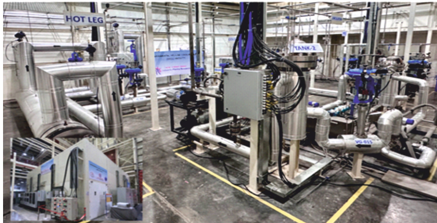
हीलियम-शीतित ब्रीडिंग ब्लैंकेट और डायवर्टर मॉक-अप से ऊष्मा निष्कर्षण के अध्ययन हेतु बनी प्रायोगिक हीलियम शीतलन लूप ईएचसीएल सुविधा Experimental Helium Cooling Loop (EHCL) facility for studies on heat extraction from helium cooled breeding blanket and divertor mock-ups
