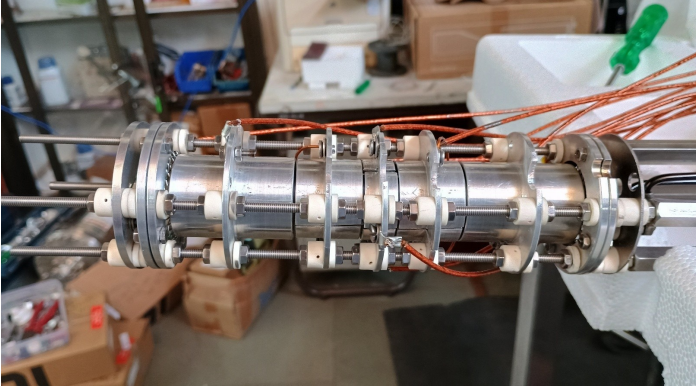
चित्र A.3.7: (ऊपर) पाँच संकेद्रित बेलनाकार रिंग इलेक्ट्रोड, ग्रिड और फ़िलामेंट से निर्मित रैखिक बेलनाकार पेनिंग-माल्मबर्ग ट्रैप का योजनात्मक आरेख।
