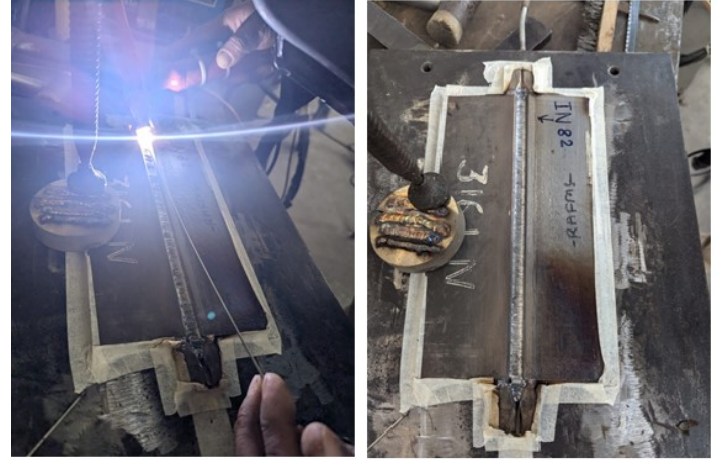
चित्र A.2.27: INCONEL-82 फिलर तार का उपयोग करके IN-RAFM – SS 316LN के असमान वेल्ड जोड़
