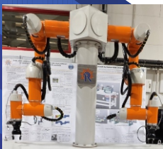
डुअल आर्म मैनिपुलेटर (डीएएम) : पात्र के अंदर रिमोट हैंडलिंग कार्यों के लिए विकसित किया गया दो भुजाओं वाला एक रोबोटिक मैनिपुलेटर
