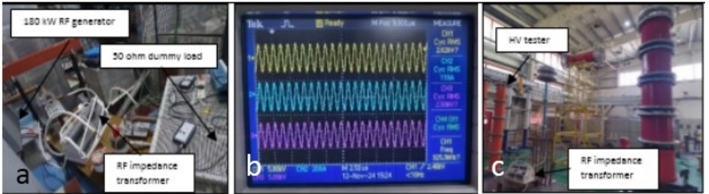
चित्र: A.2.38: (a) 180 kW, 1 MHz RF जनरेटर तथा 50 Ω RF डमी लोड का उपयोग करते हुए RF ट्रांसफॉर्मर का प्रायोगिक परीक्षण विन्यास। (b) ट्रांसफॉर्मर के 150 kW पर परीक्षण के दौरान वोल्टेज और करंट के वेवफॉर्म। ट्रांसफॉर्मर इनपुट वोल्टेज (गुलाबी: स्कोप पर 1V = वास्तविक 1V), आउटपुट वोल्टेज पीला: स्कोप पर 1V = वास्तविक 1V तथा आउटपुट करंट (नीला: स्कोप पर 1A = वास्तविक 0.5A)। (c) IPR के UHVPS सुविधा में ट्रांसफॉर्मर के प्राइमरी तथा सेकेंडरी के बीच 150 kV पर हाई-वोल्टेज पृथक्करण (आइसोलेशन) परीक्षण।
