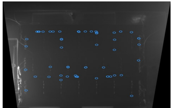
चित्र A.4.5: नए ECR प्लाज़्मा स्रोत का उपयोग करते हुए किए गए LEO प्राथमिक आर्क (arc) प्रयोग के दौरान कैचर किए गए आर्क स्थान।
