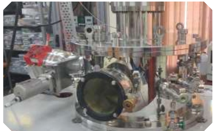
सीपीपी-आईपीआर में विकसित जड़त्वीय विद्युत-स्थैतिक परिरोधन संलयन (आईईसीएफ) आधारित न्यूट्रॉन स्रोत Inertial Electrostatic Confinement Fusion (IECF) based neutron source developed at CPP-IPR
