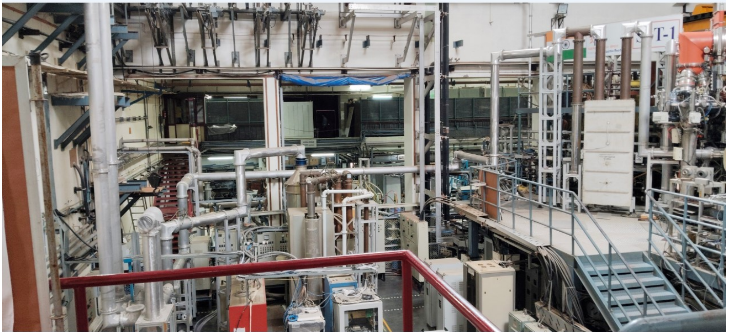
चित्र A.1.34: एसएसटी-1 में हाल ही में स्थापित एल्यूमिनियम ट्रांसमिशन लाइन और मैचिंग नेटवर्क।
