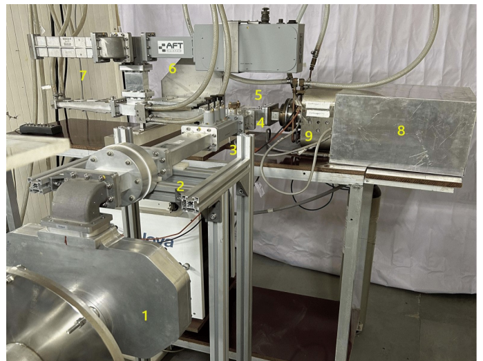
चित्र A.3.17: SYMPLE प्रायोगिक संयोजन — 1 मोड कन्वर्टर, 2 डी.सी. ब्रेक, 3 स्टब ट्यूनर, 4 डायरेक्शनल कपलर, 5 सर्कुलेटर, 6 वेरिएबल एटेन्यूएटर, 7, डमी लोड, 8, मैग्नेटॉन तथा 9 इलेक्ट्रोमैग्नेट।
