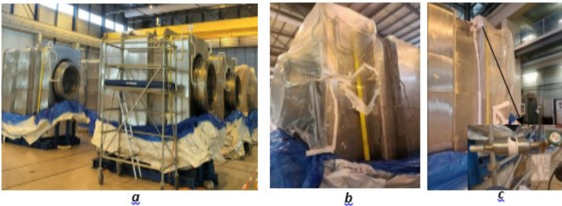
चित्र B.1.6: टोरस क्रायो-पंप हाउसिंग और TCPH का हीलियम लीक टेस्टिंग।
