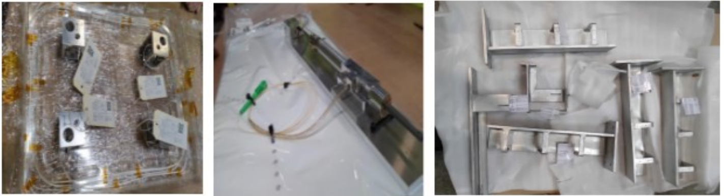
चित्र B.1.5: ऑप्टिकल सेंसर (एक्सेलेरोमीटर, डिस्प्लेसमेंट सेंसर) और डिस्प्लेसमेंट सेंसर सपोर्ट।
